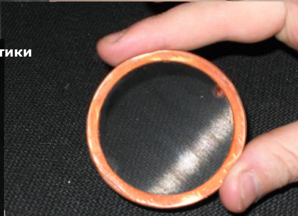
Охладитель 4К для матричного приемника для телескопа РТ-22 КрАО
