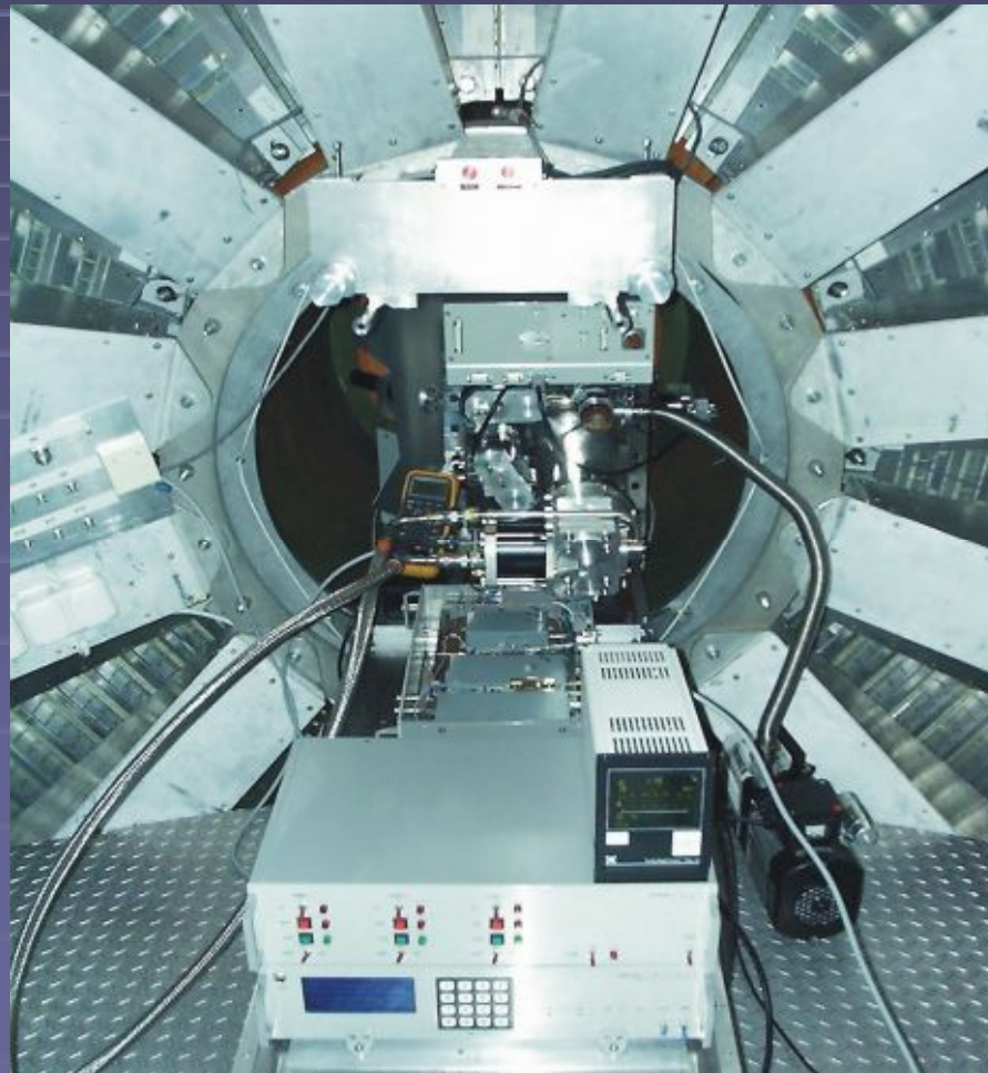
Двухчастотный двухполяризационный СИС-приемник на 13,7м антенне радиобсерватории Метсахови
