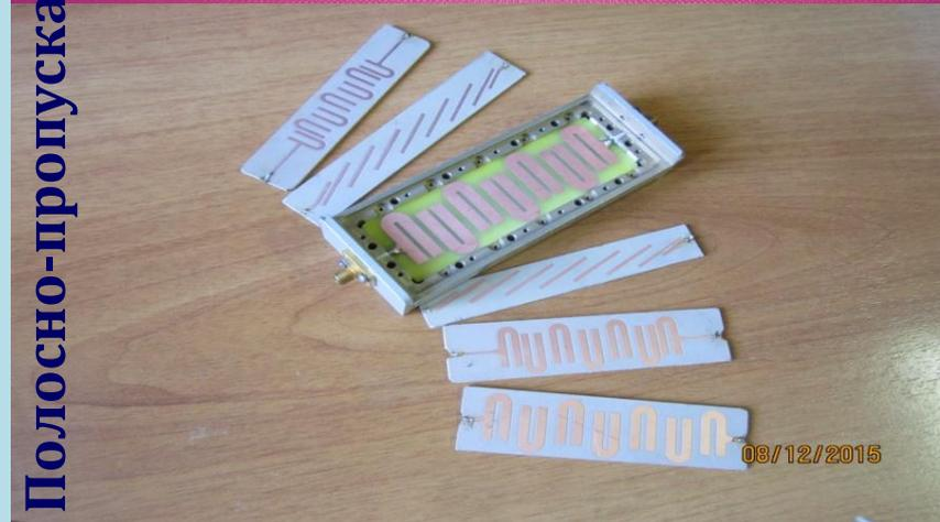
**Изготовлены и получены два малошумящих радиометрических модуля диапазона 4.4-5.0 ГГц (совместно с НПФ «Микран», г. Томск), разработанные по ТЗ для РАТАН-600:**
