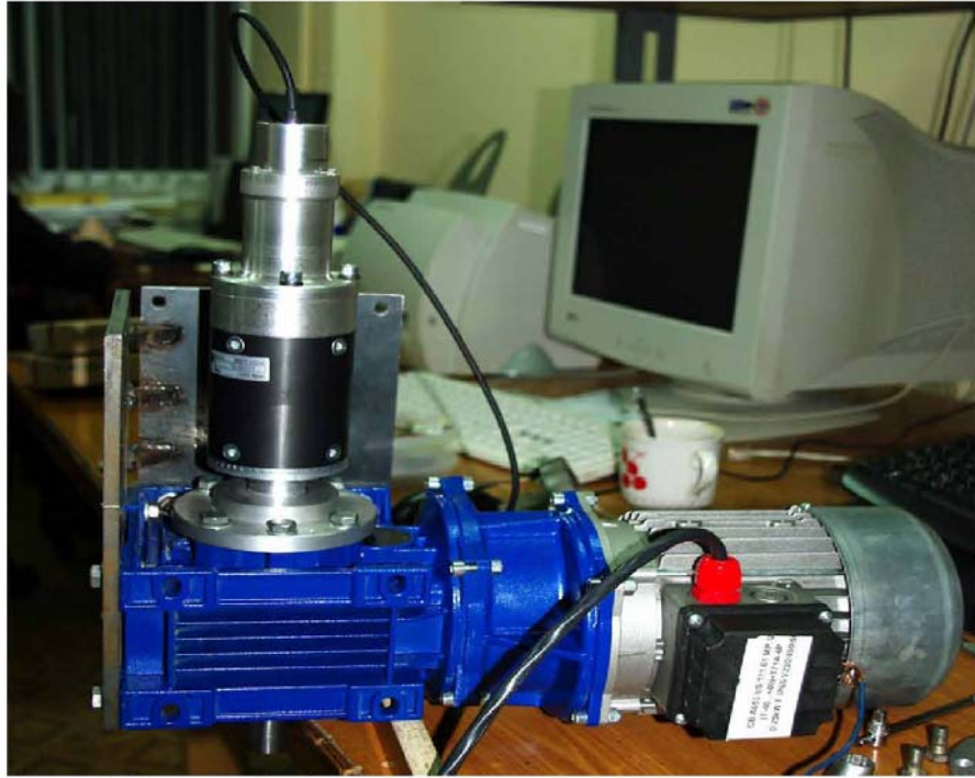
Рисунок 21. Внешний вид нового мотор-редуктора управления работой купола.
