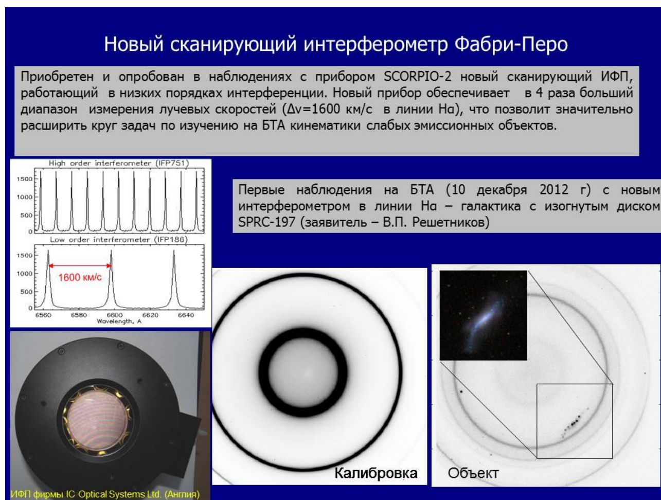
Рисунок 17. Характеристики внедренного на УСУ БТА интерферометра Фабри-Перо.
