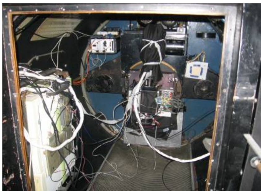
Рис. 17. Наблюдательный комплекс в стакане первичного фокуса БТА. Слева блок из трех компьютеров для управления прибором и приема данных.
