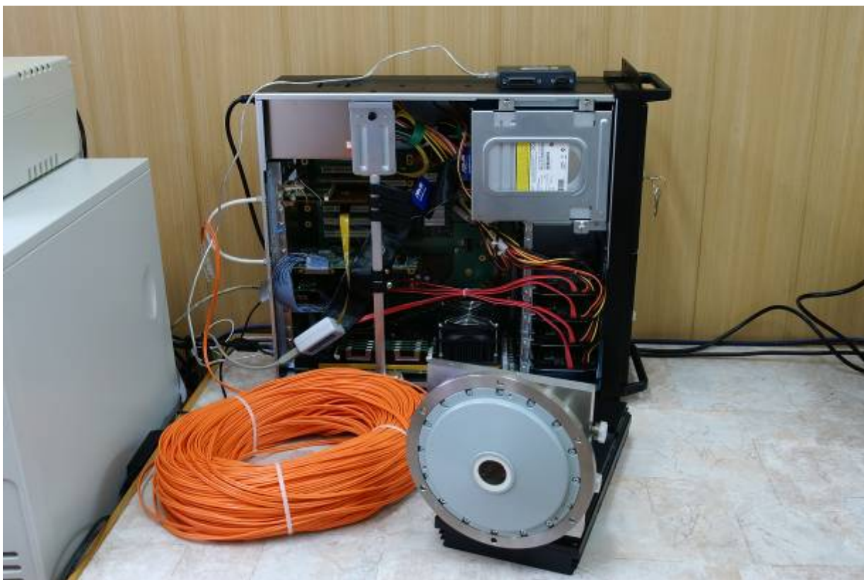
Рис. 5. Общий вид системы ввода цифровых изображений (на заднем плане) с испытательной камерой на pnCCD (на переднем плане)
