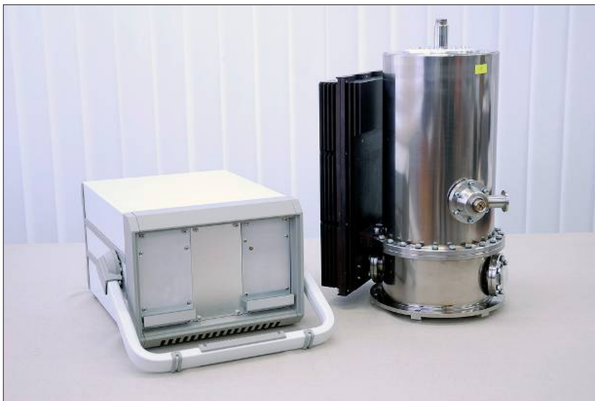
Рис. 1. Криостатируемая ПЗС-камера (справа криостат с контроллером, слева блок питания)
