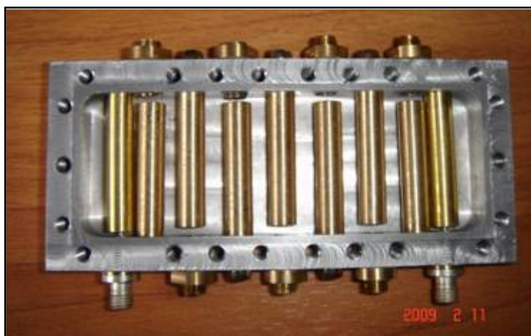
Рис. 6. Один из 4-х полосно-пропускающих фильтров на встречных стержнях диапазона 13 см.
