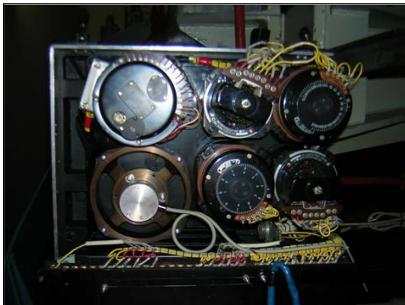
Рис. 2. Общий вид датчиков азимутальной оси телескопа БТА после замены.
