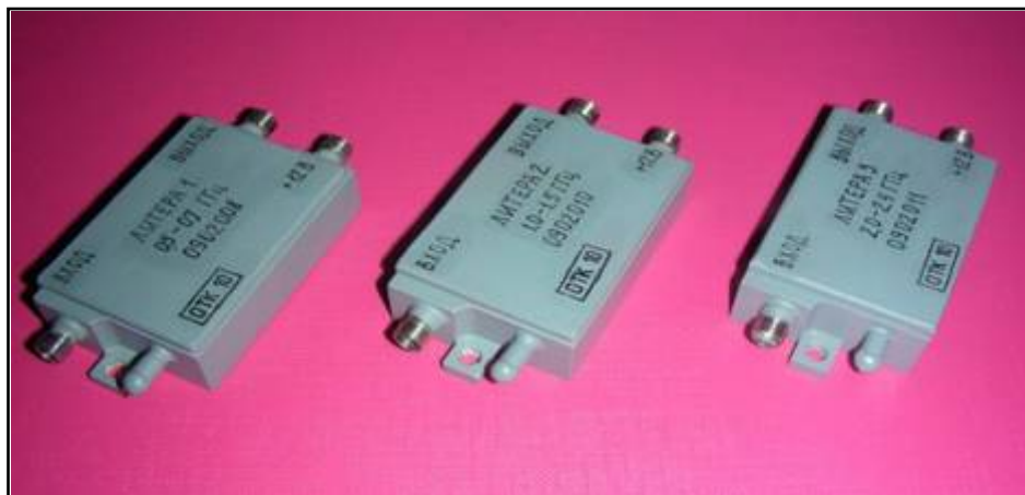
Рис. 5. Выходные усилители с высоким динамическим диапазоном для системы «Октава».
