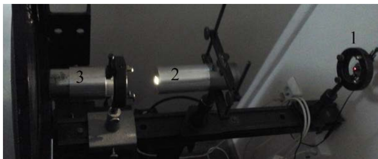
Рисунок 2 – Юстировочная часть передвижного стенда. Обозначения: 1 – лазер, 2 – источник комбинированного спектра (ртуть + люминофор), 3 – оптика осветителя щели (1:4)
