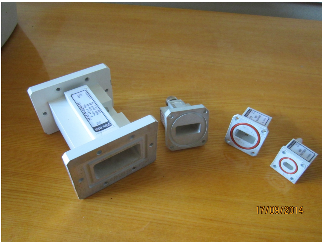
Рис.1. Линейка неохлаждаемых МШУ НПФ «Микран», г. Томск, внедренных на радиотелескопе РАТАН-600
