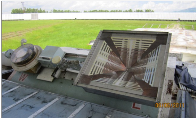
Рис. 39. Слева - фокальная линия облучателя №1. Слева направо: облучатель В.Н. Дикого для мониторинга помех и широкополосный облучатель «Eleven». Справа – фокальная линия облучателя №2. Слева направо: трехчастотный комплекс «Эридан», юстировочный комплект, система MAPC-3 (крышки для наглядности сняты).
