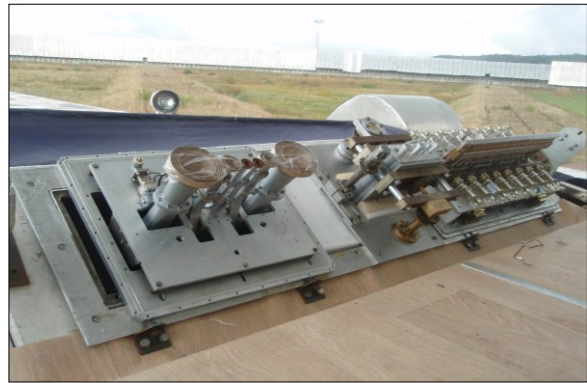
Рис. 39. Слева - фокальная линия облучателя №1. Слева направо: облучатель В.Н. Дикого для мониторинга помех и широкополосный облучатель «Eleven». Справа – фокальная линия облучателя №2. Слева направо: трехчастотный комплекс «Эридан», юстировочный комплект, система MAPC-3 (крышки для наглядности сняты).
