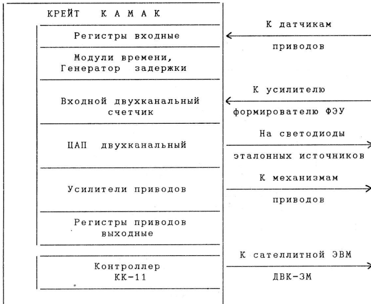
Рис. 3. Блок-схема электроники управления фотометра.
