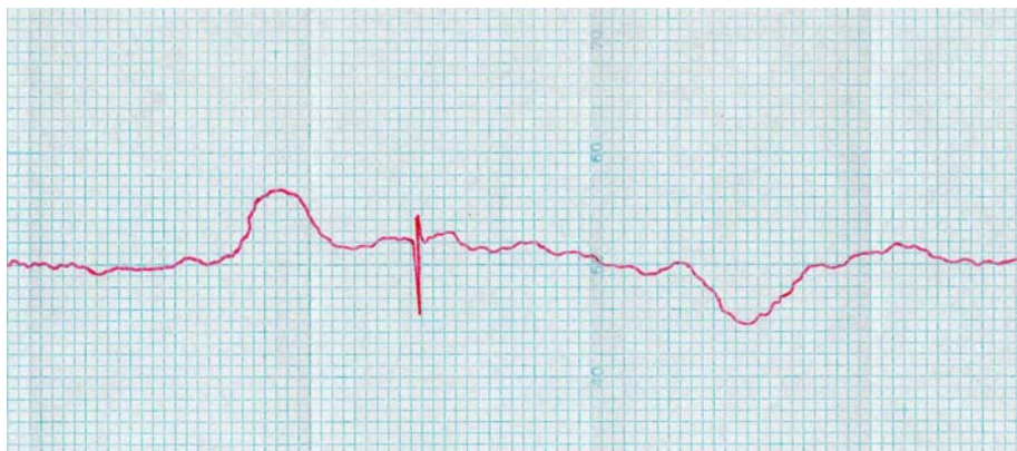
Рис. 6. Первое наблюдение на радиотелескопе РАТАН-600: радиоисточник PKS 0521-36, длина волны 3,9 см, 12 июля 1974 г.
