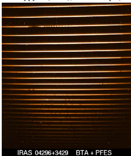
Рис.2. Эшелле-фрагмент источника IRAS04296+3429, полученный автором на эшелльном спектрографе PFES телескопа БТА.
