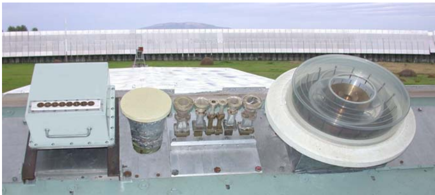
Рис.2 Первичные облучатели комплекса радиометров сплошного спектра. Слева – матрица МАРС-2.
